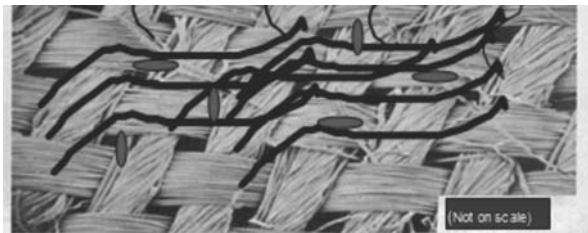
Fig. 5. Stratul activ aflat în tranziția de fază formează o structură lamelară cu excelente proprietăți de lubrifiere
